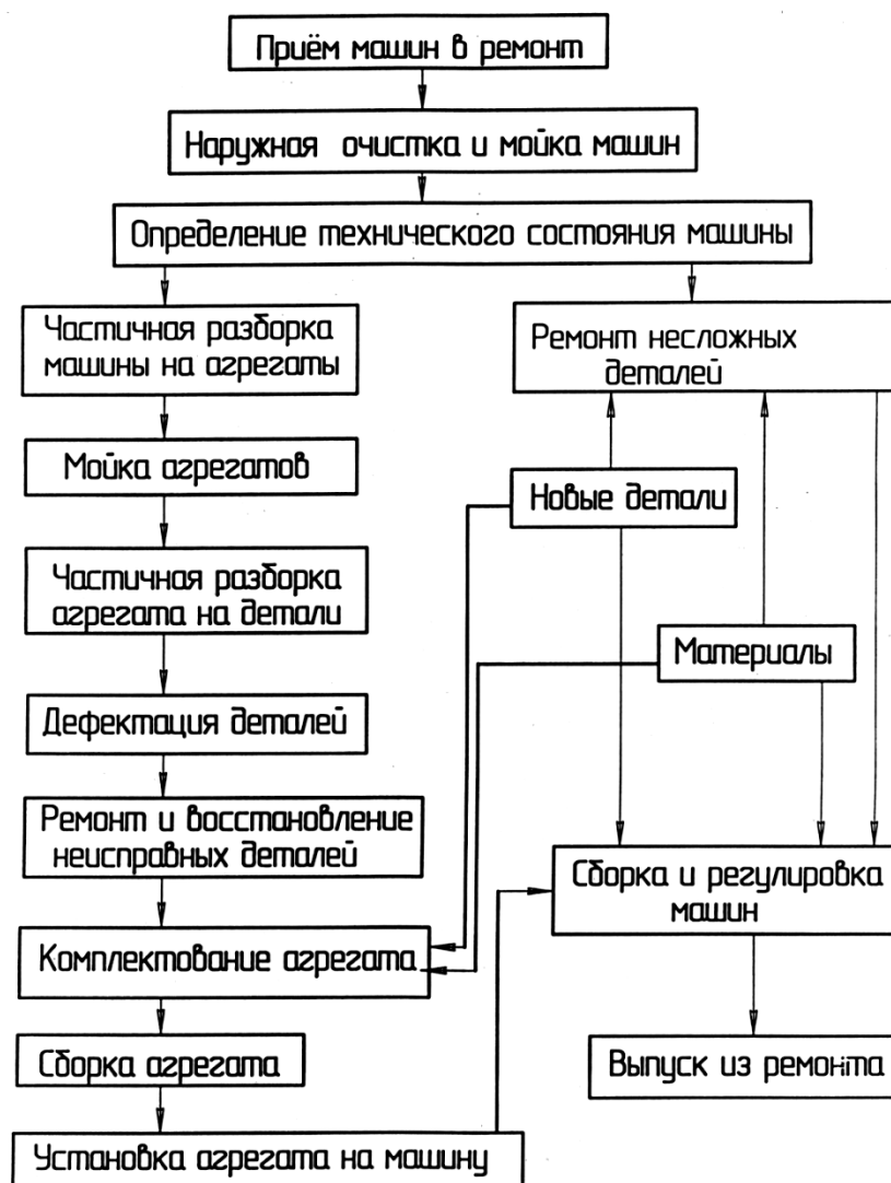
Рис. 2 Схема технологического процесса ремонта
