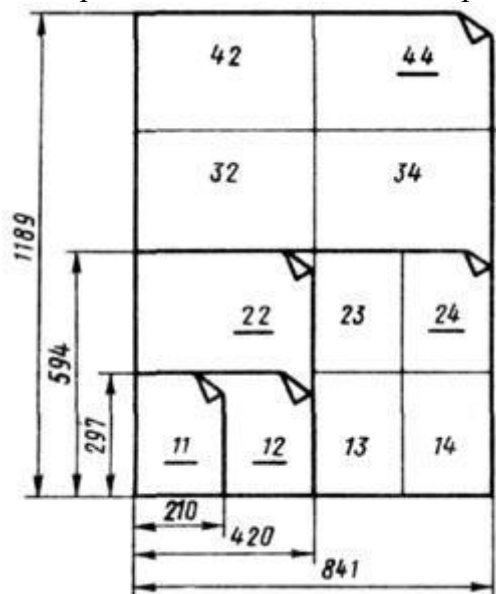
Рис. 3. Схема построения форматов (чертой обозначены основные форматы)
